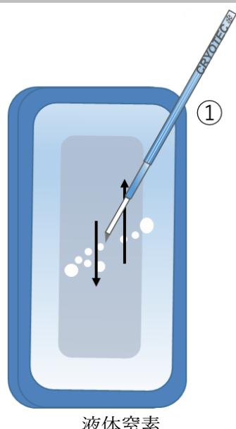
1. シート上のドロップ内に卵子/胚を確認した後、直ちにクライオテックを液体窒素中に投入し、冷却速度を上げるために気泡が発生しなくなるまで振る(超急速冷却)(①)。
