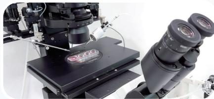
**Compatibilidad con AHA láser** que permite a los embriólogos realizar AHA utilizando la misma placa RtU con el nuevo diseño de la placa de calentamiento.
